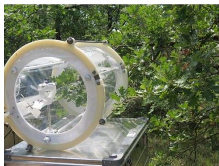
FIGURE 2.21 Chambre dynamique en Téflon utilisée pour la mesure des taux d'émission de COVB à l'Observatoire du chêne pubescent (O 3 HP) de l'Observatoire de Haute Provence.
