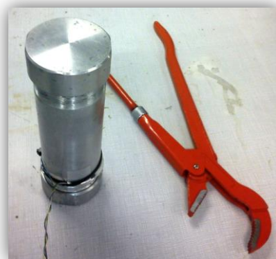
Figure 4-1 : Schéma et vue d'une capsule en aluminium pour l'étude des MCP dans le calorimètre XL (côtes en mm)
