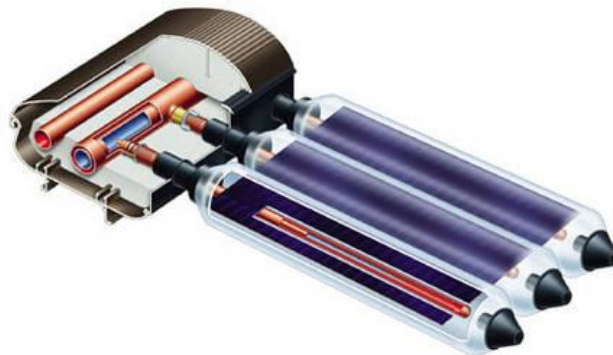
Figure 1-14 : Transfert de chaleur par circulation directe concentrique sur le capteur Vitosol 200-T
