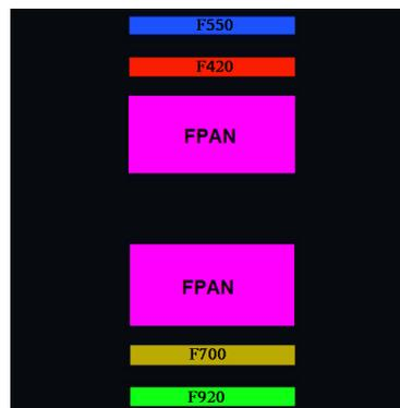
Figure 1-26 Disposition des filtres sur STC
