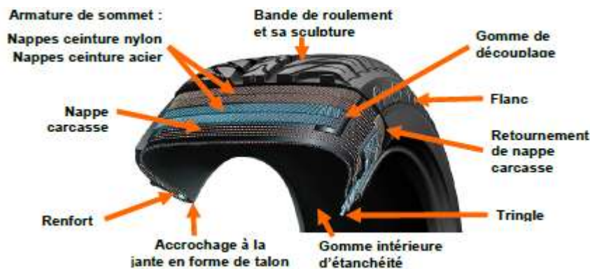
Fig.i.1. Architecture de l'enveloppe du pneumatique (Source : Michelin)
