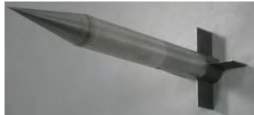
(b) Projectile aéro-stabilisé BASIC FINNER.
