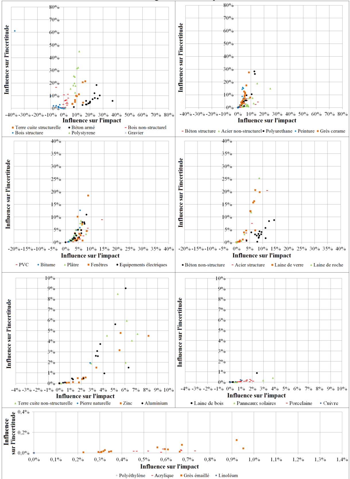
Figure IV. 6 - Influence des composants des maisons individuelles sur l'impact et sur les incertitudes pour l'indicateur changement climatique
