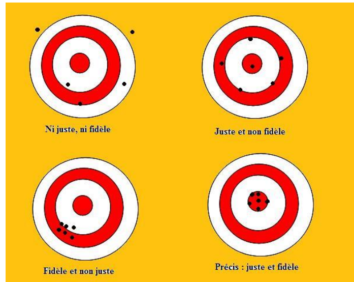
Figure I.6 - Schématisation de la justesse et de la fidélité [ISO5725-1, 1994]
