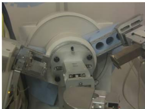
Figure 4 : Diffractomètre Philips MPD-PRO (gauche) utilisant une géométrie Bragg-Bretano (droite)
