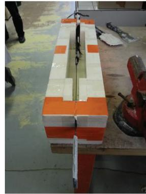
Figure 137 : Utilisation des thermocouples permettant de mesurer la température à l'interface des joints thermiquement isolés avant de mouler des isolants
