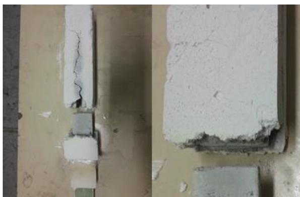
Figure 149 : Fissuration à la surface de l'Isolant A après essai
