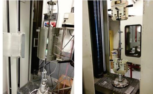
Figure 87 : Essai sur l'éprouvette CFRP-T20-1 en utilisant des capteurs laser (à gauche) et l'éprouvette CFRP-T20-4 en utilisant des capteurs LVDT (à droite).
