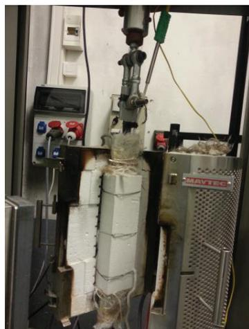
Figure 135 : Protection thermique d'un joint par l'Isolant A
