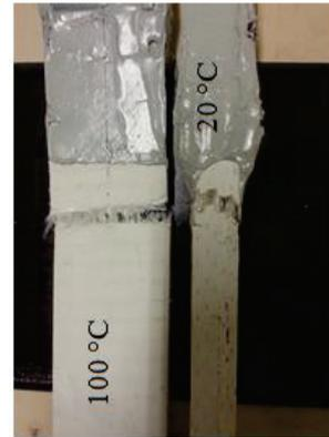
Figure 110 : TRC\* - Mode de rupture « pull-out » à 20 °C et 100 °C
