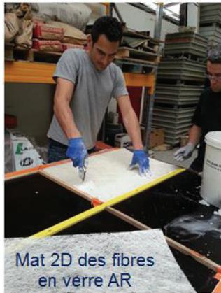
Figure 77 : Mise en œuvre de composite par moulage au contact
