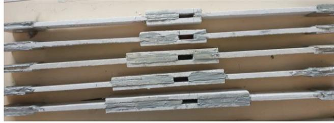
Figure 126 : Série d'échantillon TRCiD permettant de déterminer la longueur de la zone de collage  $L_c$ .
