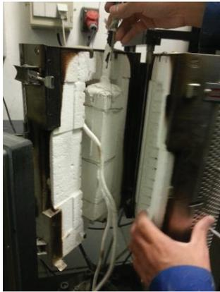
Mise en œuvre de l'essai sur l'éprouvette Isolant A
