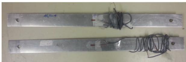
*Figure 81 : Éprouvettes de traction en Aluminium instrumentée par des jauges*
