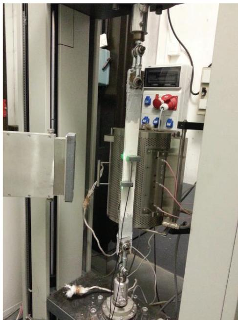
*Figure 80 : Mesure de déformation sur l'éprouvette TRC\*-T20-1 par des LVDT*
