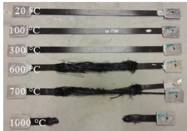
Figure 94 : Photos d'éprouvettes après essai
