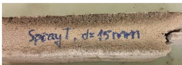
Figure 148 : Surface du PROMASPRAY®T après l'essai
