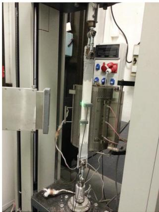
*Figure 89 : Mesure de déformation par des capteurs laser et des capteurs LVDT sur l'éprouvette TRC\*-T20-1*
