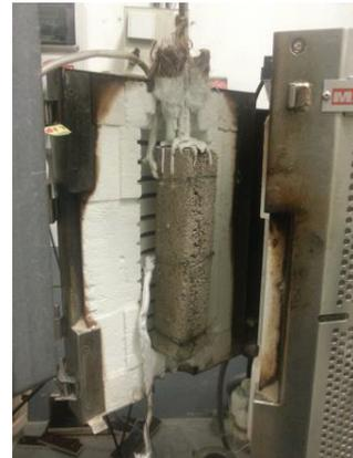
Eprouvette SprayT après d'essai
