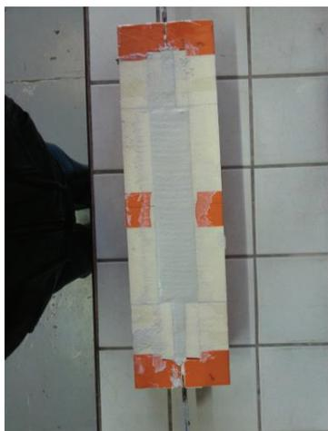
Figure 134 : Fabrication des échantillons thermiquement isolés (Isolant A)
