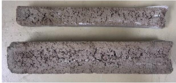
Figure 163 : Epreuves « SprayT-d15-V30-1 » et « SprayT-d25-V30-1 » de PROMASPRAY®T avec 1,5 et 2,5 cm d'épaisseur après essai
