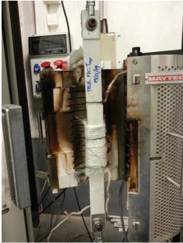
Figure 129 : Isolation thermique de la zone de collage Lc+50
