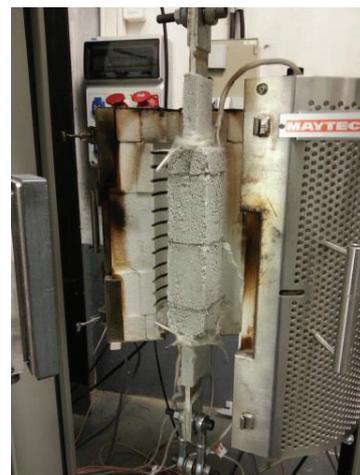
Figure 136 : Protection thermique d'un joint par le PROMASPRAY®T
