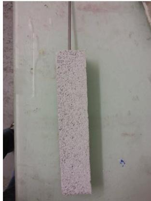
Eprouvette SprayT avant d'essai
