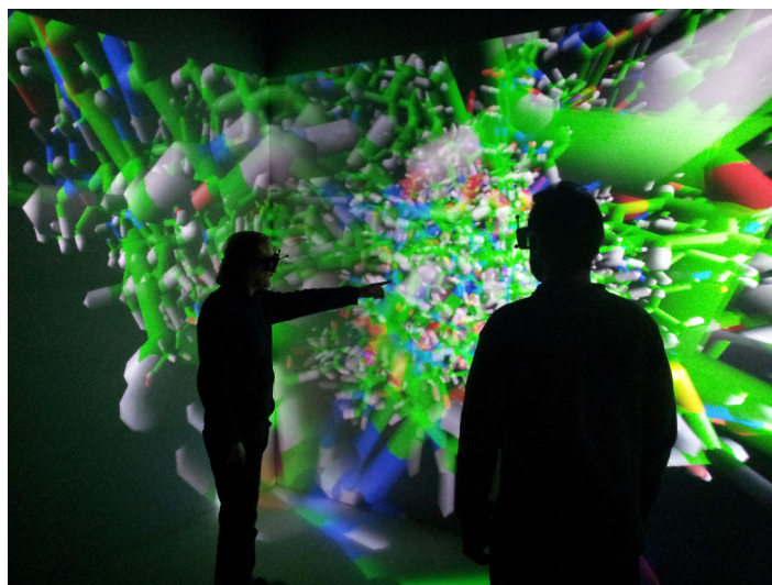
FIGURE 2.3 – Exemple de EVE, système CAVE composé de 4 écrans (gauche, face, droite et sol), présent au LIMSI-CNRS sur le campus de l'université Paris-Sud.
