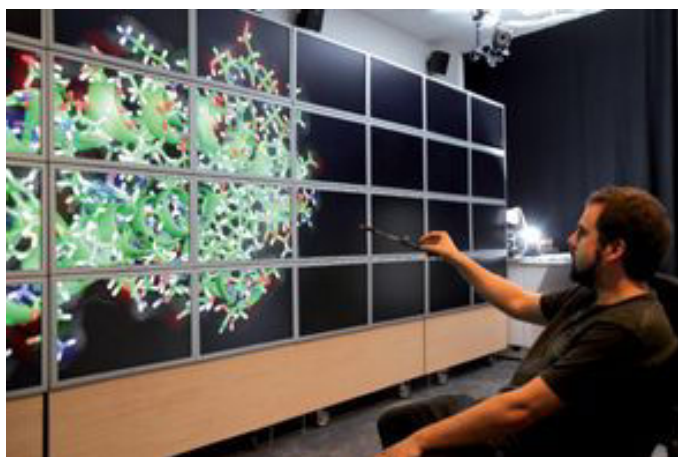
FIGURE 2.2 – Exemple de WILDER, mur d'écrans de 6 m sur 2 composé de 75 écrans, présent au sein du bâtiment Digiteo sur le campus de l'université Paris-Sud.
