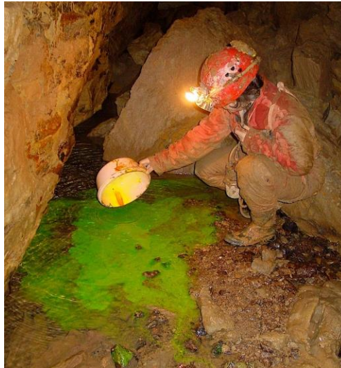
Figure 8 : Injection de traceur à partir d'un réseau souterrain.
