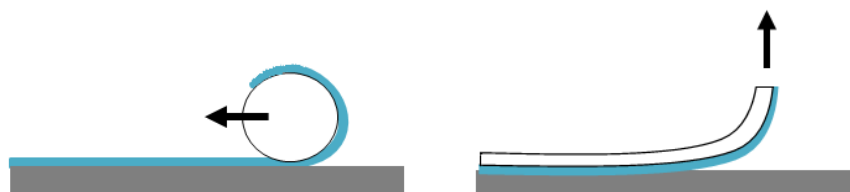
Figure I- 20 : Configurations adaptées de l'essai de pelage a) Pelage au rouleau b) Pelage avec renfort
