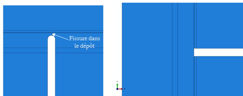
Figure III-25 : Entailles du modèle de flexion 4 points (à gauche) et du modèle de cisaillement (à droite)
