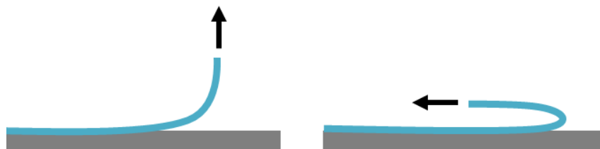
Figure I- 19 : Essai de pelage a) à 90^\circ b) à 180^\circ
