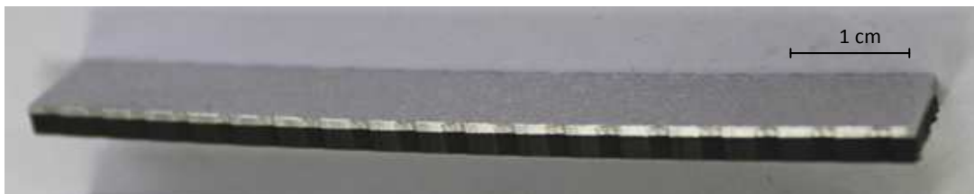
Figure II-14 : Eprouvette de l'empilement N°2 déformée sous l'effet des contraintes résiduelles d'élaboration
