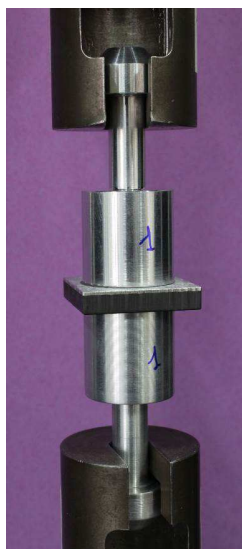
Figure III- 7 : Configuration d'essai de traction sur l'empilement N°2
