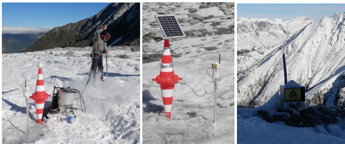
FIGURE 3.14 – Geocubes installés sur le glacier d'Argentière.
