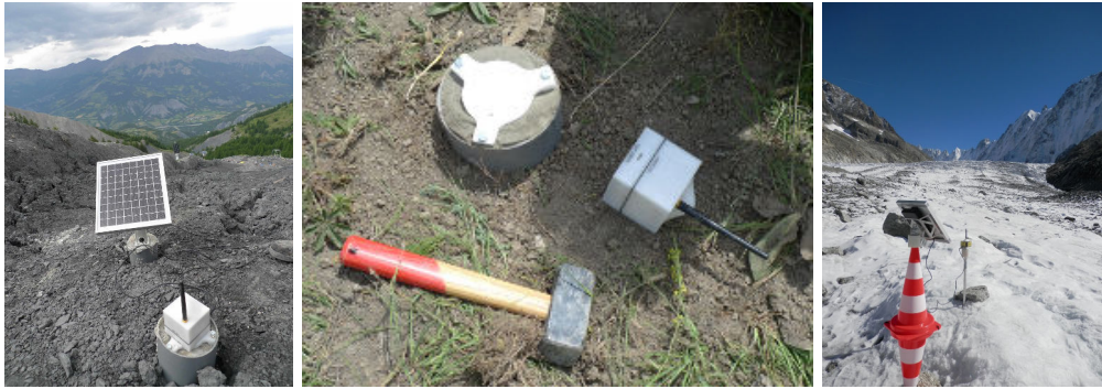
FIGURE 1.5 – Déploiement de Geocubes sur le terrain (photos de gauche et du centre : O.Martin).
