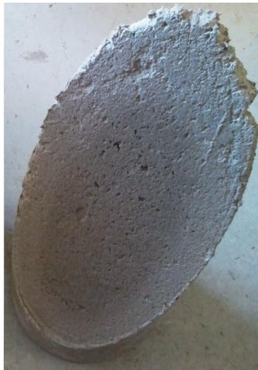
FIGURE 2.4 – Demi-éprouvette d'enduit isolant après rupture adhésive de l'éprouvette référencée 2.25.I.a. La zone plus foncée à l'interface correspond à la zone où le séchage à cœur n'était pas terminé à 28 jours.
