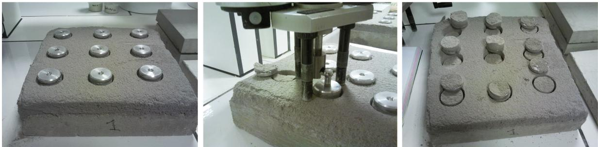
FIGURE 2.16 – L'essai pull-off d'enduit isolant avec, de gauche à droite : une éprouvette avec forages pastilles collées ; en cours d'essais ; les modes de rupture obtenus.
