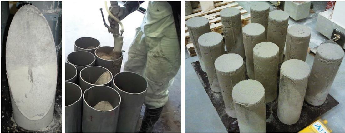
FIGURE 2.3 – De gauche à droite : un substrat béton dont la surface a été préparée ; la projection de l'enduit isolant ; les éprouvettes finales.
