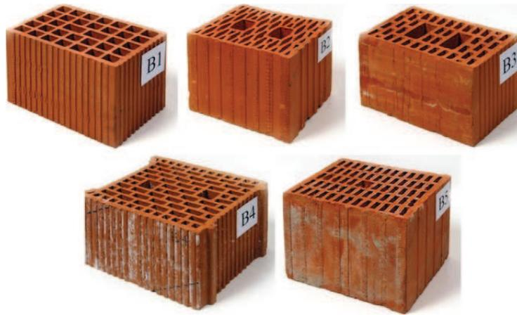
FIGURE 4.6 – Différentes briques en terre cuite alvéolées testées par Tomazevic and Weiss (2012).
