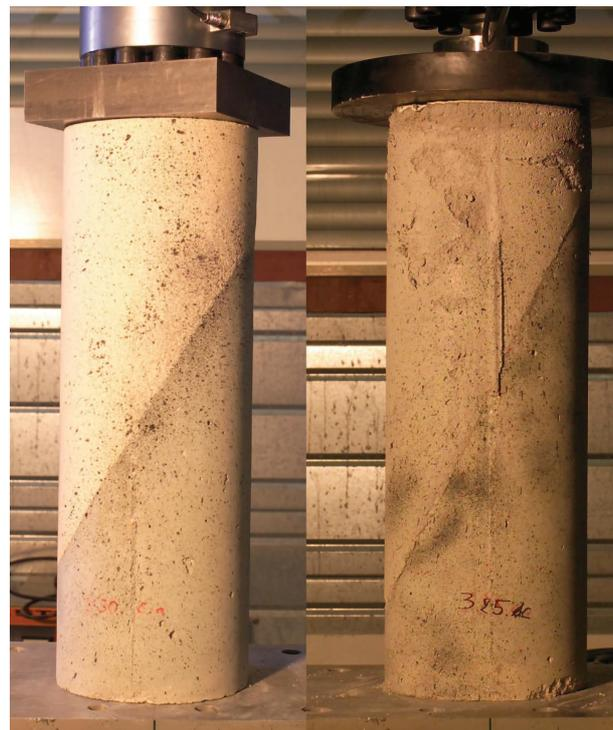
FIGURE 3.16 – Exemple de différences de luminosités obtenues entre une éprouvette MGF (2.30.C.a, à gauche) et ISO (3.25.I.c., à droite).
