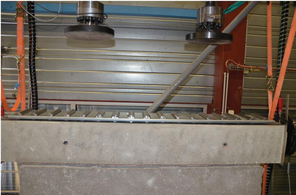
FIGURE 8.6 – *Système de rouleaux avant la pose de l'UPN 300.*
