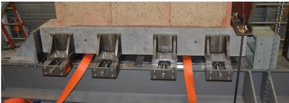
FIGURE 8.3 – Position des mors de serrage/centrage.
