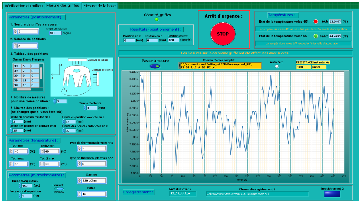
Figure 166 : Programme d'acquisition de la résistance expérimentale (onglet Mesure des griffes)
