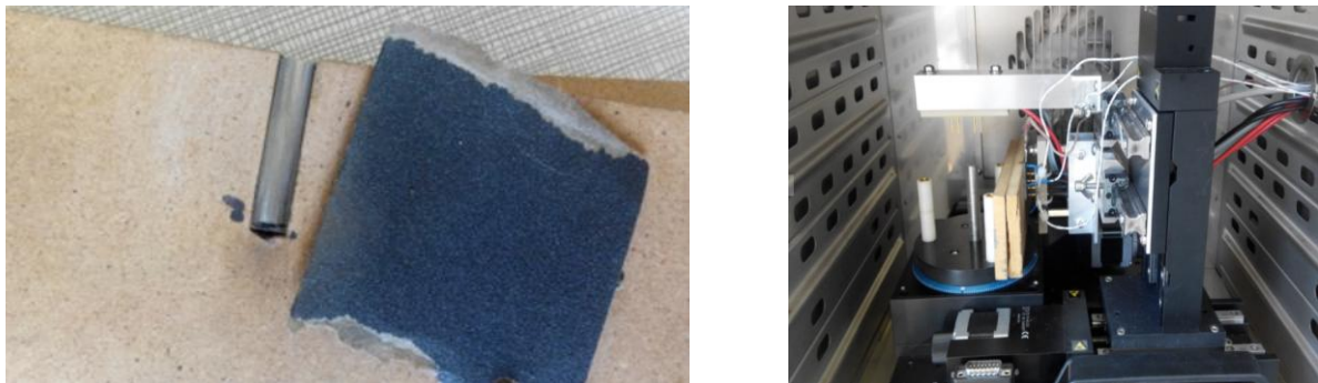
Figure 103 : Photographie d'une tige sur le porte-échantillon et du dispositif expérimental
