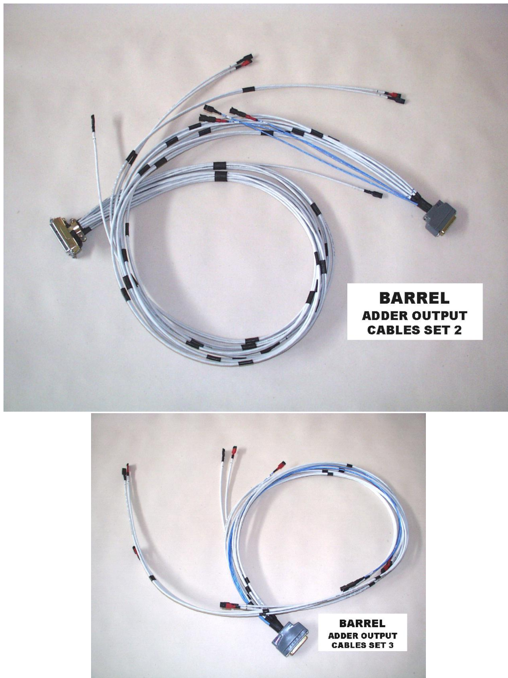
FIG. 3.11 – Câbles de sorties des cartes Adders, en haut côté externe (se connectant au Patch-Panel) et en bas côté interne.
