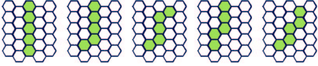
FIG. 2.4 – Type de modèles recherchés pour le second niveau de trigger du télescope de fluorescence. Chaque hexagone représente un pixel de la caméra.
