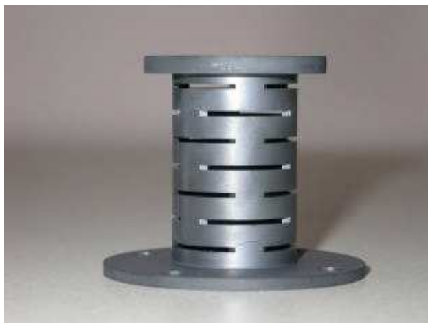
Figure II.8. Four carbone constitué de 7 fentes latérales (5 fentes effectives)
