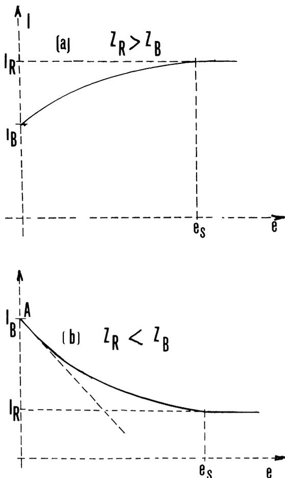
FIG. 1. — Variation de l'intensité rétrodiffusée  $I$  en fonction de l'épaisseur  $e$  du revêtement :  $Z_R$  = numéro atomique du revêtement ;  $Z_B$  = numéro atomique du matériau de base ;  $I_R$  = intensité rétrodiffusée à saturation par le revêtement ;  $I_B$  = intensité rétrodiffusée à saturation par le matériau de base ;  $e_s$  = épaisseur du revêtement correspondant à la saturation.
