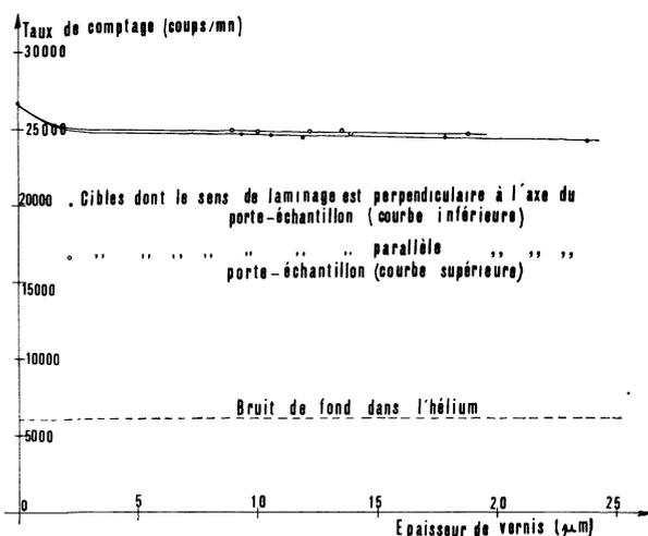
FIG. 6. — Variation du taux de comptage en fonction de l'épaisseur de vernis pigmenté ( $Z = 10$ ). Détecteur : scintillateur et photomultiplicateur. Radioélément :  $^{14}\text{C}$ . Milieu ambiant : Hélium.
