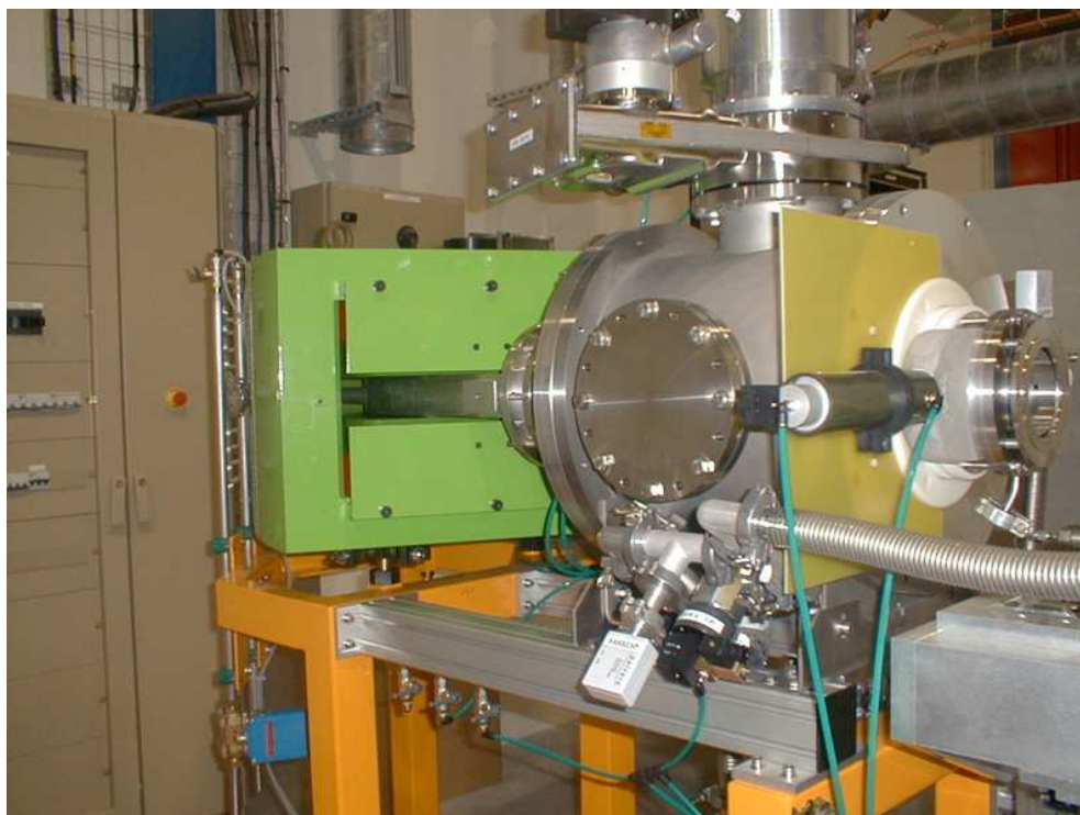
Photo N° 5: Enceinte d'extraction et dipôle électromagnétique
