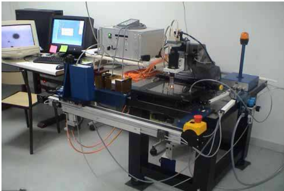
FIG. 4.20 – Photo du robot échangeur d'émulsions installé au laboratoire de scan de Lyon.
