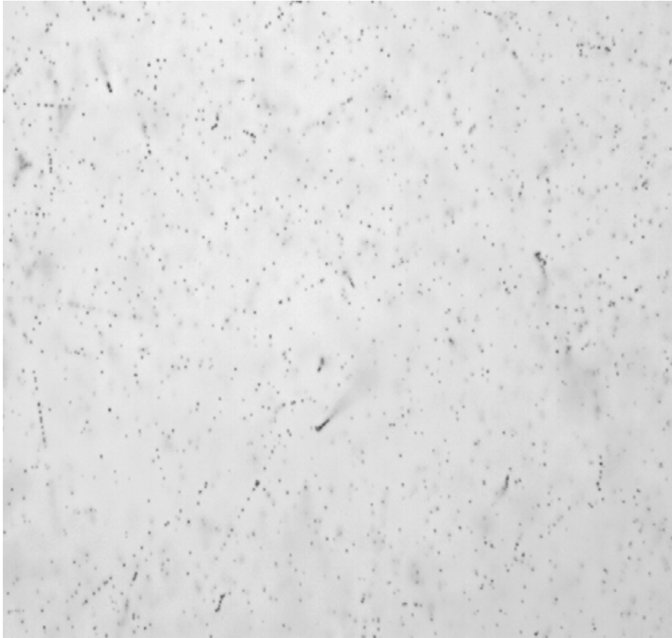
FIG. 5.11 – Image de la couche du haut de l'émulsion, obtenue avec l'objectif à sec.
