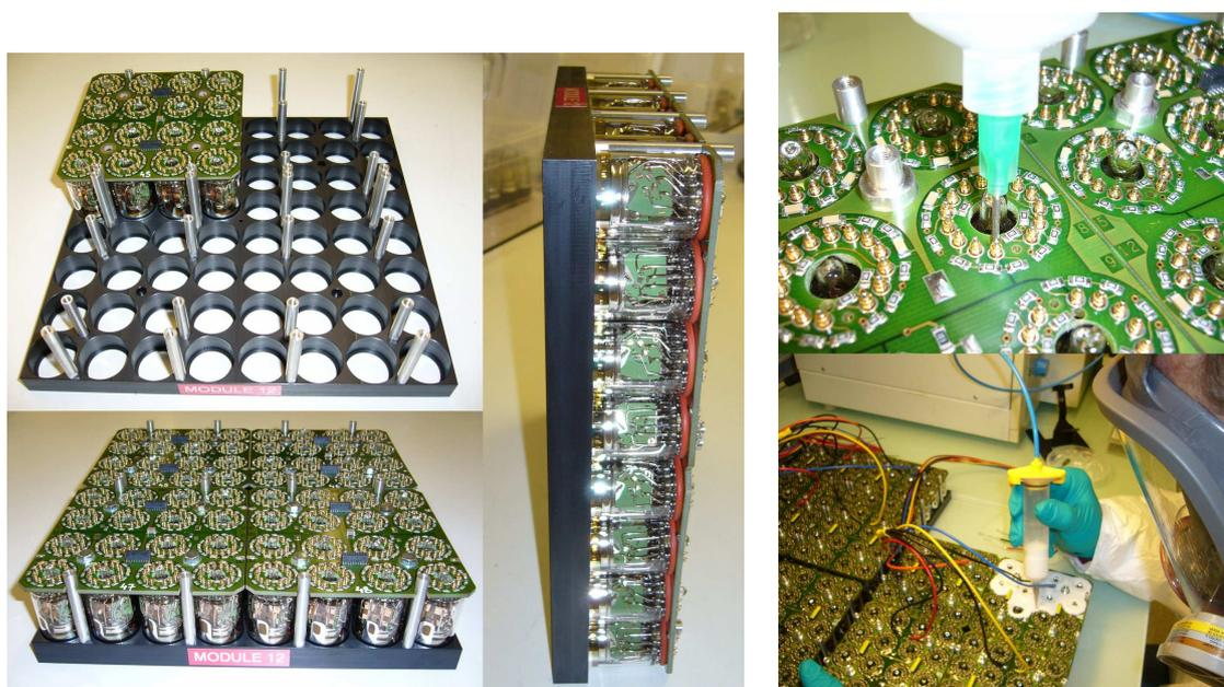
FIG. 2.12 – Ensemble de photographies du montage des modules de photomultiplicateurs : à gauche le montage mécanique des photomultiplicateurs et à droite la procédure d'isolation électrique.
