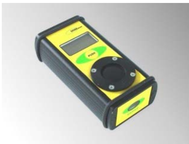
Figure 1-17 : Détecteur à semi-conducteur : le Doseman
