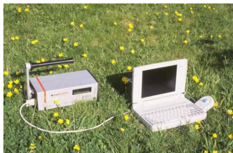
Figure 1-15 : La chambre d'ionisation Alphaguard.
