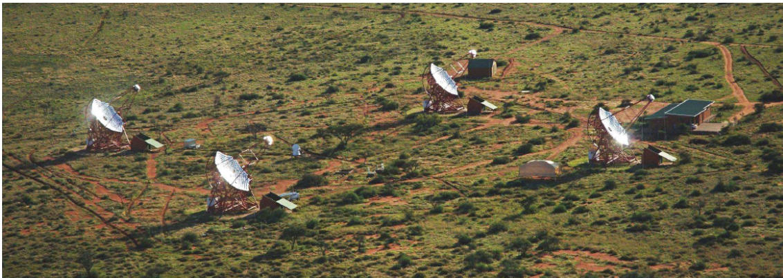
FIGURE 4.10 – Réseau des quatre télescopes de l'expérience H.E.S.S. (phase I), situé en Namibie à 1800 m d'altitude. Les télescopes sont placés aux sommets d'un carré de 120 m de côté, dont les diagonales sont orientées selon les directions Nord-Sud et Est-Ouest.
