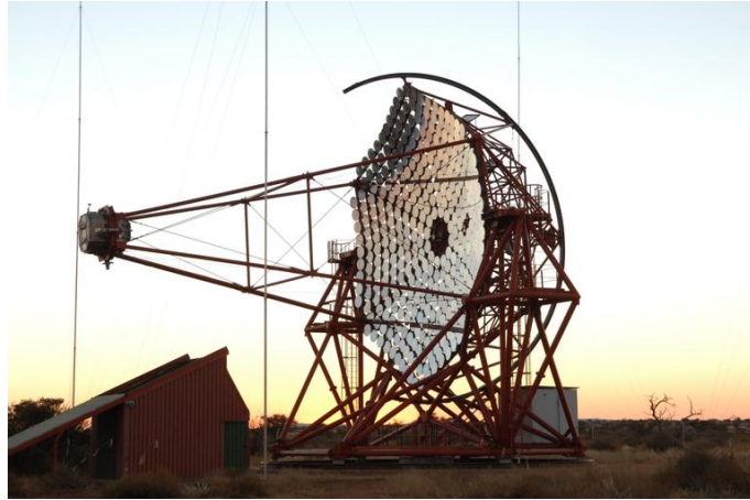
FIGURE 4.11 – Photographie d'un télescope de l'expérience H.E.S.S. La surface réfléchissante est composée de 380 facettes circulaires de 60 cm de diamètre, couvrant une surface de 107 m 2 . Les photons issus du rayonnement Cherenkov sont focalisés sur la caméra, placée à 15 m du miroir (Crédit : Claude Delhayé - Photothèque CNRS).
