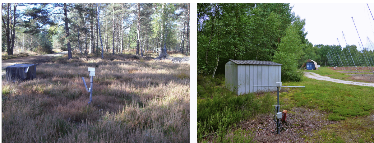
FIGURE 2.24 – A gauche : une antenne du bras Est-Ouest et un scintillateur sous sa bâche plastique protectrice. A droite : une antenne sensible à la polarisation Nord-Sud du champ. Sont également visibles : le conteneur (au fond), le réseau du DAM et l’ancien abri métallique d’un scintillateur du LAL.
