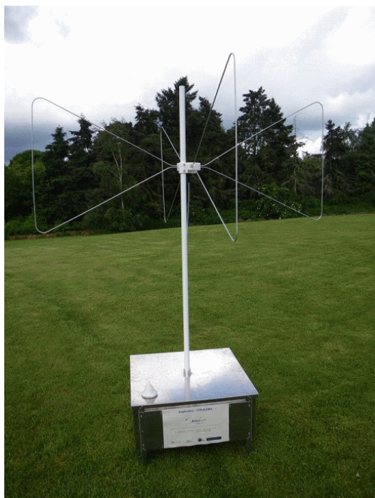
FIGURE 4.23 – Vue de la nouvelle génération de la station autonome développée par CODALEMA. L'ensemble de l'électronique est contenu dans le caisson métallique.
