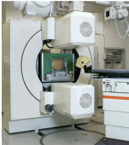
Figure 1.19 – Dispositif de tomographie à émission de positons en ligne installé en cave M au GSI [44].
