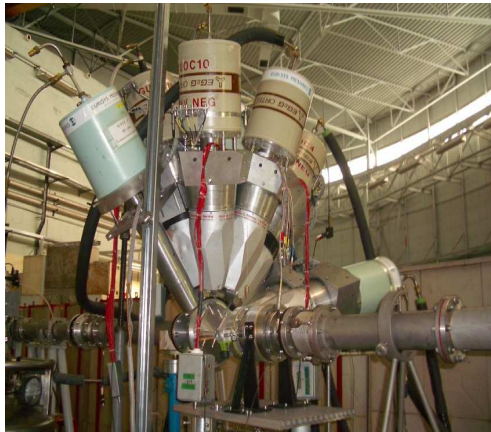
FIGURE 5.3 – Dispositif de détection des photons \gamma .
