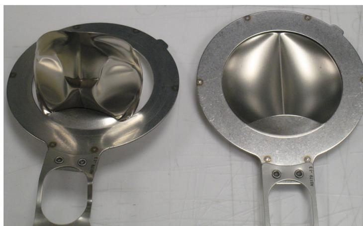
(c) Disques de rupture rompu (gauche) et intact (droite)
