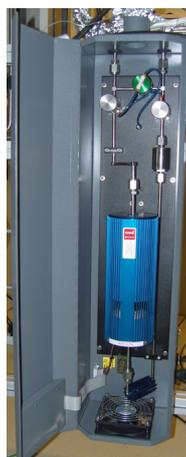
FIGURE 3.9 – Le filtre de purification SAES
