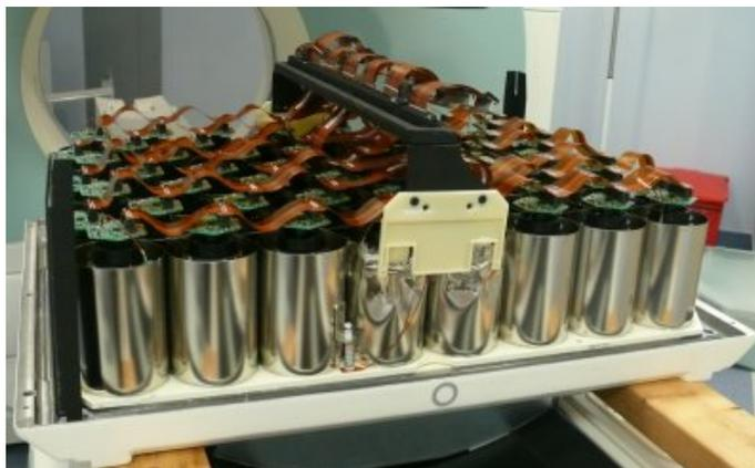
FIGURE 1.5 – Matrice de PM d'une gamma caméra (Siemens Healthcare Symbia)
