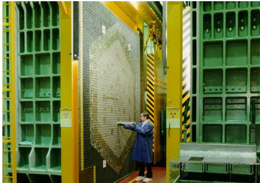
FIGURE 2.3: Vue des deux tables horizontales de l'installation ZPPR
