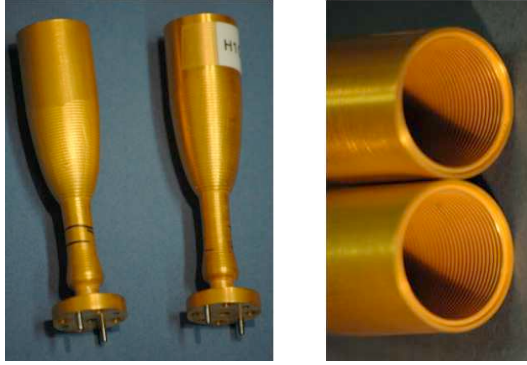
FIG. 5.1: Cornets corrugués développés pour CLOVER par nos collaborateurs de l'université de Manchester.
