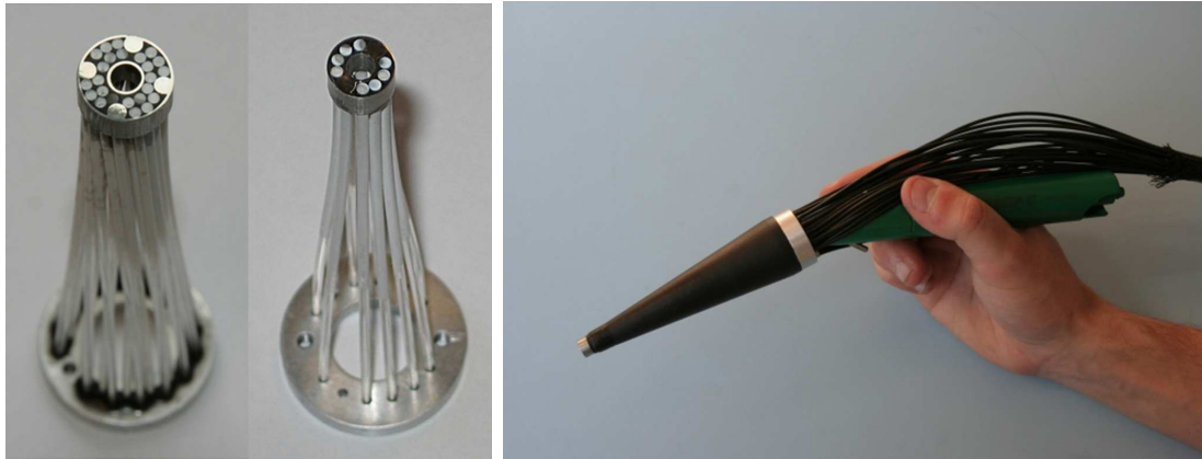
FIGURE 3.1 – Têtes de détection grand champ et petit champ de la sonde TRIOP (gauche) association entre la sonde TRIOP et l’outil d’exérèse (aspirateur ultrasonore) (droite)
