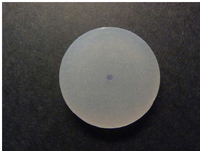
FIGURE 5.2 – Fantôme radioactif en gel d'Agar avec cylindre central de 3,5 mm de diamètre et 2 mm de profondeur.
