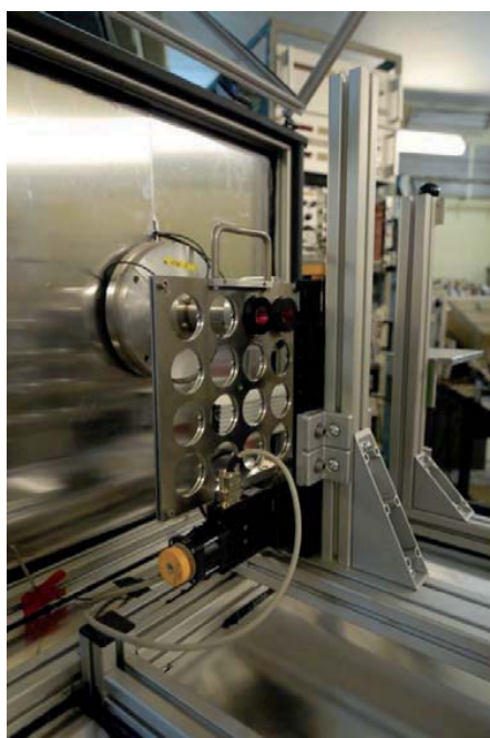
Figure 37 - Passeur d'échantillons automatisé à l'aide de platines motorisées (X,Y). Sur cette photographie, il supporte le porte-échantillon spécifique aux boîtes de Petri.
