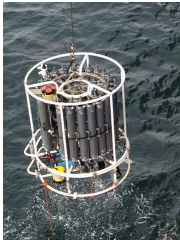
Tewaterlating van de CTD-rosette. Deze bestaat uit een frame waarop verschillende 12 liter Niskin-bemonsteringsflessen gemonteerd staan, samen met sensoren voor conductiviteit – temperatuur – diepte, alsook met een opwaarts en een neerwaarts kijkende acoustic doppler current profiler (voor het meten van stromingssnelheden) (KEOPS 2-campagne).
