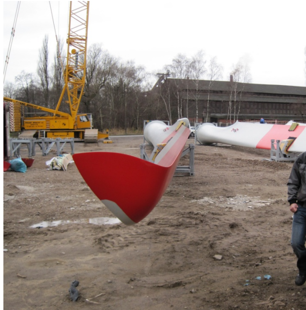
Abbildung 2.10 31 : Winglet an einem Rotorblatt einer ENERCON E82 WEA
