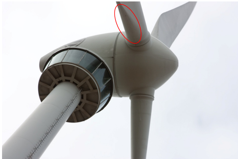
Abbildung 4.11 89 : Rotorblatt der E-66 im wurzelnahen Bereich in der Ausführung mit dicker abgerundeter Hinterkante. In einer anderen Ausführung ist dieses Rotorblatt mit einem geraden Abschnitt an der Hinterkante zwischen Saug- und Druckseite bekannt (vgl. Abbildung 4.12).
