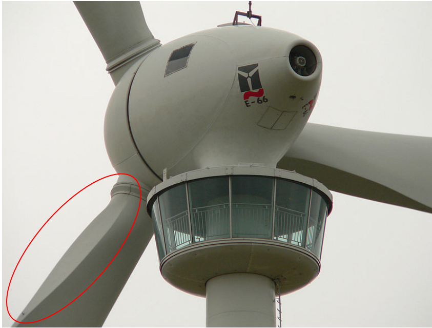
Abbildung 4.12 90 : E-66 Rotorblatt mit geradem Abschnitt an der Profilhinterkante im wurzelnahen Bereich (auch „Stumpfe Hinterkante“ genannt).
