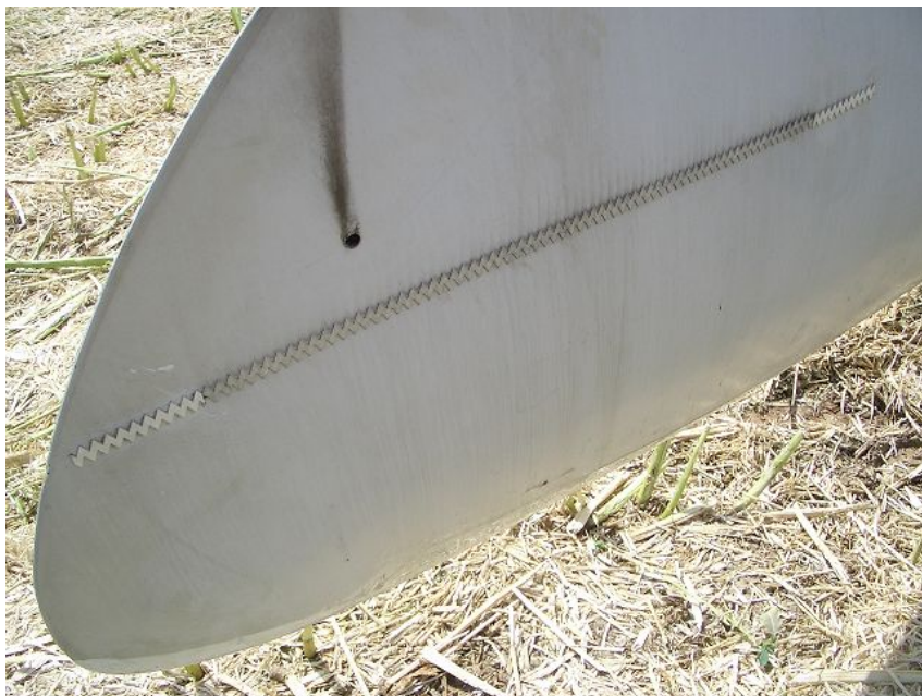
Abbildung 2.20 44 : Zick-Zack-Band auf der Blattoberseite im Bereich der Rotorblattspitze
