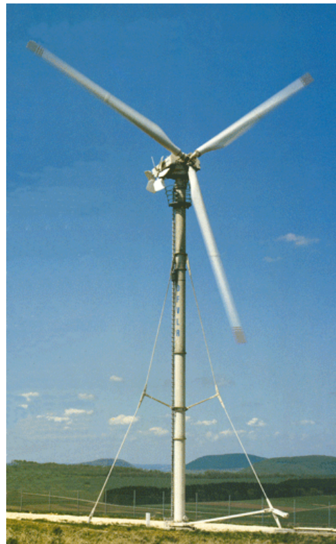
Abbildung 4.2: Leeläufer DEBRA-25 auf dem Testgelände der Universität Stuttgart in Schnittlingen auf der Schwäbischen Alb
