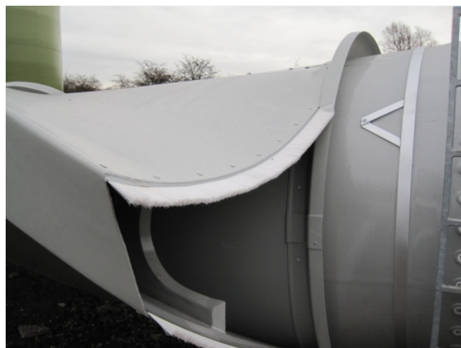
Abbildung 2.8 27 : Rotorblatt einer ENERCON E-82 im Bereich Blattanschluss zur Nabe
