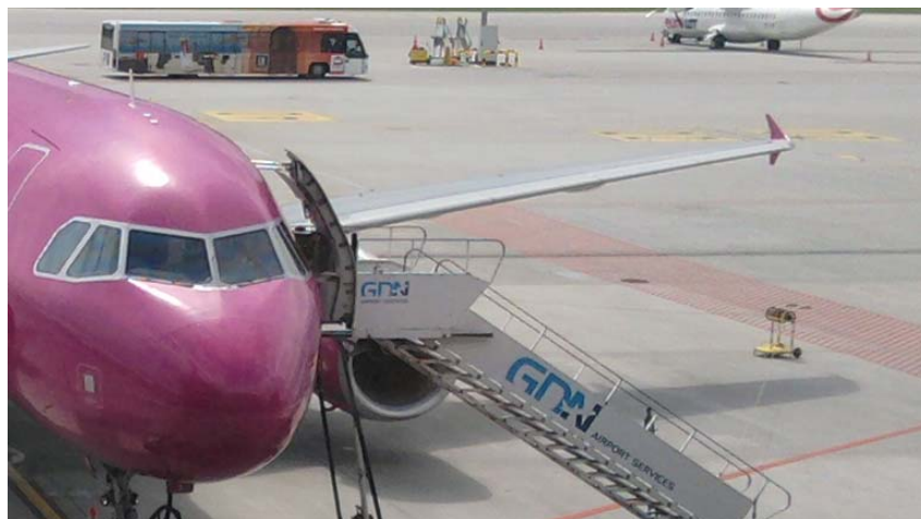
Abbildung 2.11 32 : Winglet an der Flügelspitze eines Verkehrsflugzeuges
