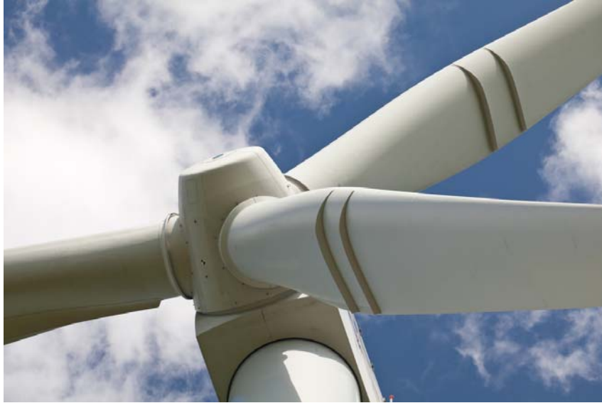
Abbildung 2.6 25 : WEA REPOWER 6M mit zweifach ausgeführter Stall-Barrier
