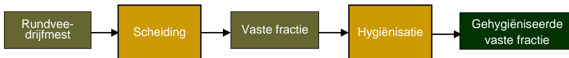
Afbeelding 3: Processchema van hygiëniserie van de vaste fractie na mechanische scheiding van rundveedrijfmest tot een gehygiëniseerd product.
