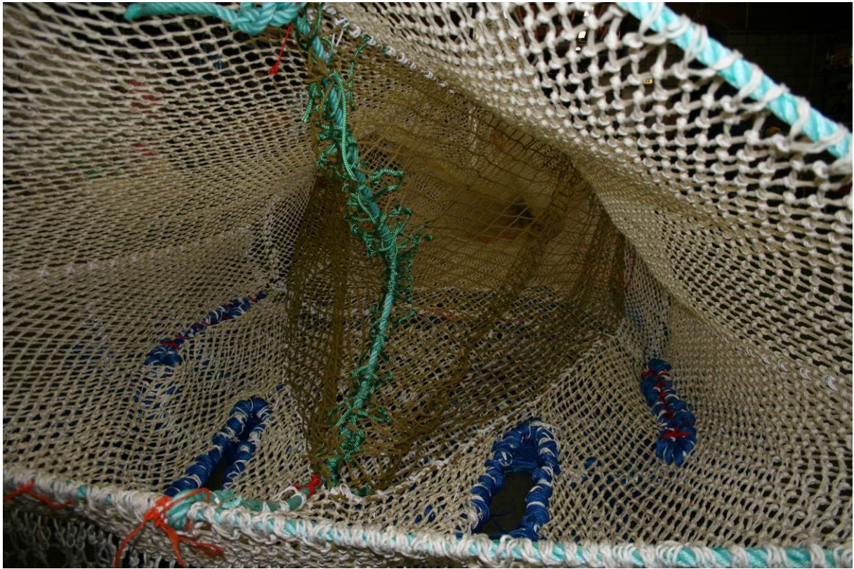
Figuur 80. Foto van de Albregtse sorteerkuil, getest op de ARM22. Het bruine netwerk in het midden is het sorteerpaneel (135 mm maas tussen de knopen) voor tong, onder met blauwe randen gaten om de stenen en andere benthos te lozen.
