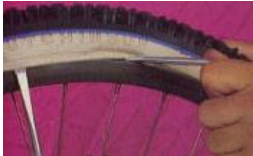
Figura 128. Extracción de cubierta
