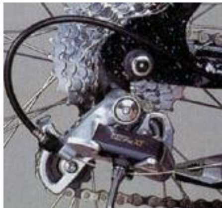
Figura 131. Tensión del cable del cambio trasero
