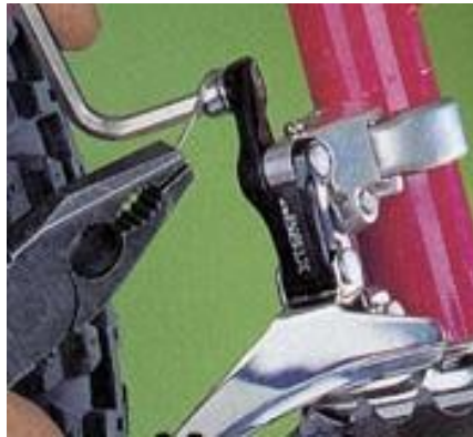
Figura 132. Apriete del cable del cambio delantero
