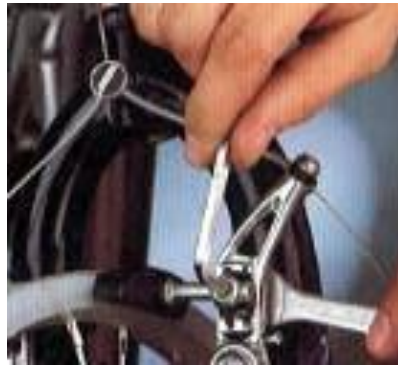
Figura 130. Operación de sacar los espárragos de las zapatas
