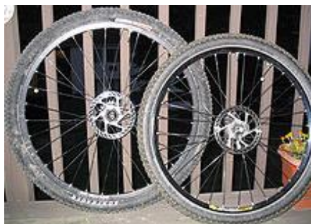
Figura 60. Rueda de MTB de 29" y de 26"
