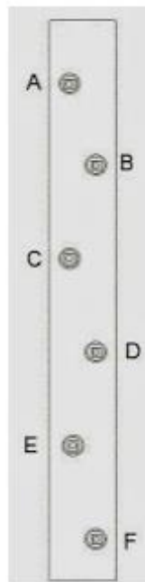
Figura 127. Colocación de los niples de los radios en la llanta
