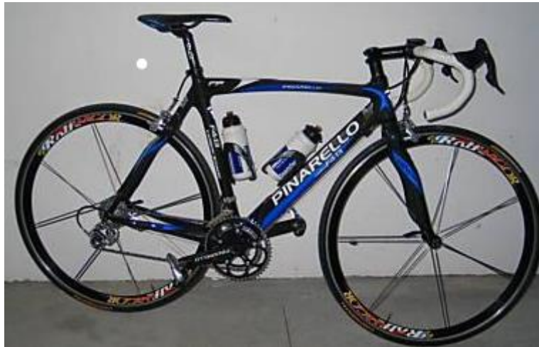
Figura 59. Bicicleta con cuadro de fibra de carbono
