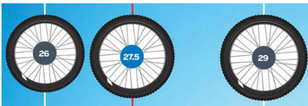
Figura 62. Esquema de rueda de MTB de 26", de 27,5" y de 29"
