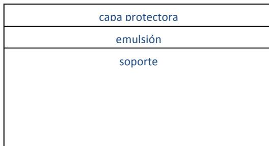
Figura 11 Corte longitudinal de la película cinematográfica.
