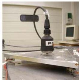
Figure II - 24 : Montage effectué pour tester les capteurs PCB-1 et 2
