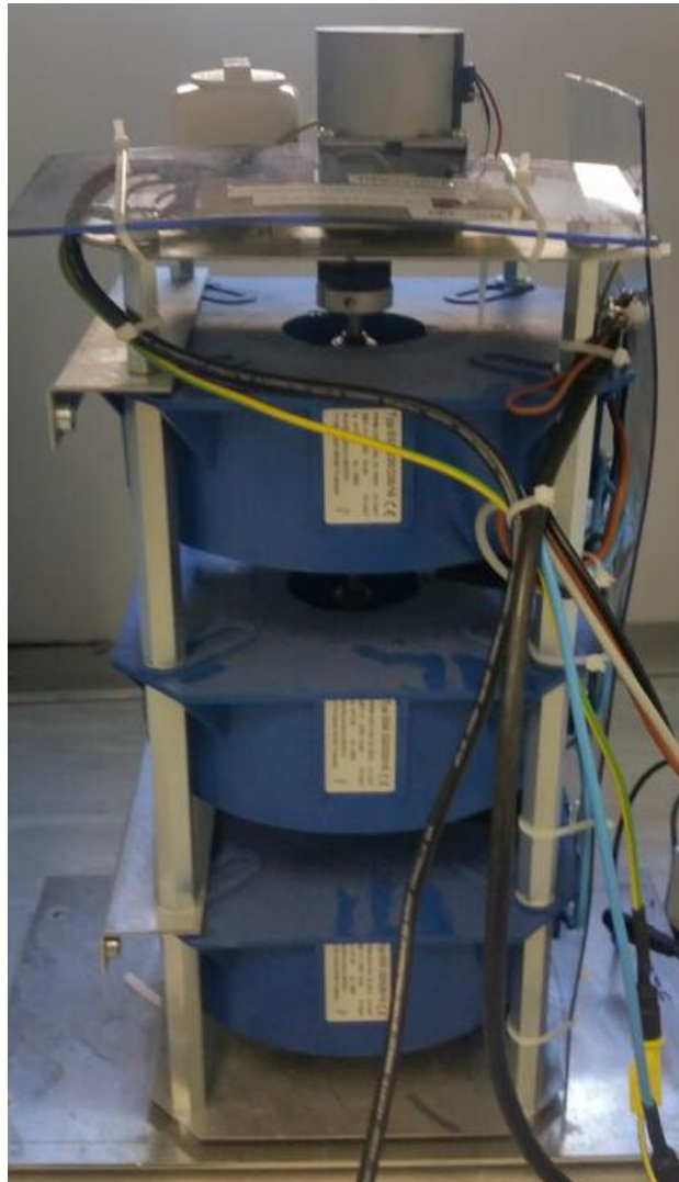
Figure 20 : Transformateur variable 11kVA, 230V, 50...60 Hz
