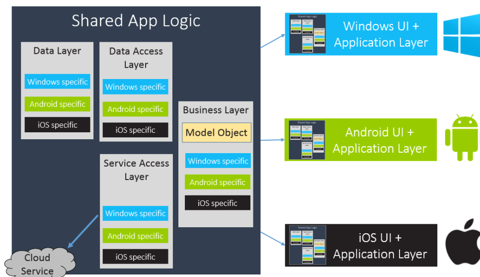
Figure 19 : Structure Shared Code Projet
