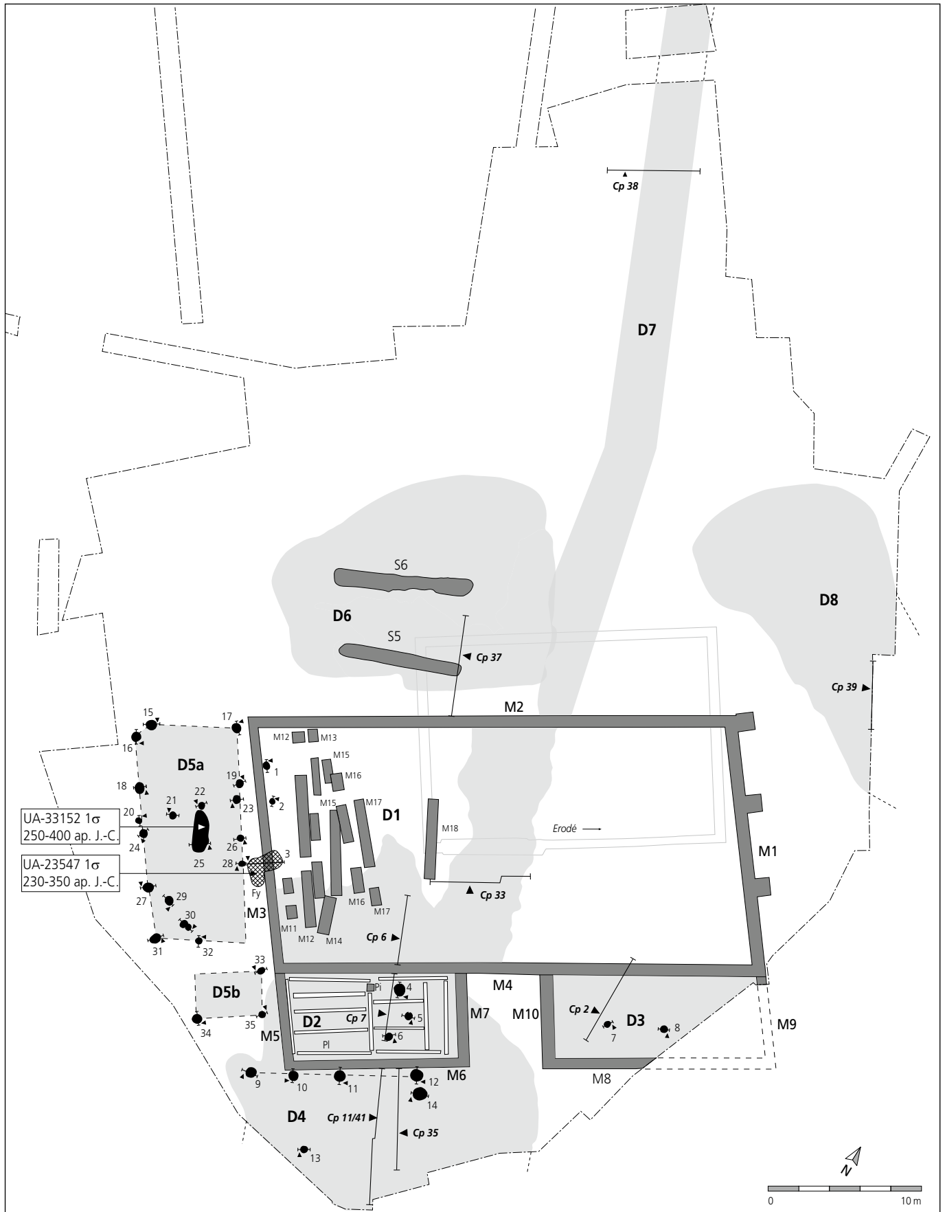
Fig. 140. Alle, Les Aiges, phase 4. Plan du bâtiment 3 et des structures connexes, situation des coupes 2, 6, 7, 11/41, 33, 35, 37-39 et résultats des datations 14 C. D1 : halle ouest du bâtiment 3 ; D2-D3 : annexes au bâtiment 3 ; D4 : construction sur poteaux ; D5a-b : édifices sur poteaux ; D6 : grenier sur solins ; D7-8 : tronçons de chemins ; M1-10 : murs du bâtiment 3 et de ses annexes ; M11-18 : piles ou dés de pierres sèches ; S5-6 : solins du grenier D6 ; 1-2, 4-24, 26-35 : trous de poteau ; 3 : foyer ; 25 : fosse ; Pi : pile ; Pl : plancher. En filigrane : bâtiment 2 antérieur (phase 2).
