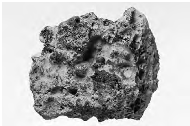
Fig. 343. Alle, Les Aiges. Calotte de forge à composition argilo-sableuse (SAS).
