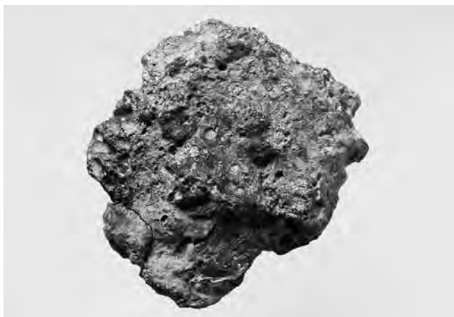
Fig. 345. Alle, Les Aiges. Calotte de forge dense (ou lourde), riche en métal.
