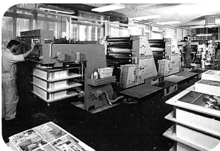
Au tableau de commande de la presse offset quatre couleurs, l'imprimeur effectue tous les réglages avec une précision électronique.
