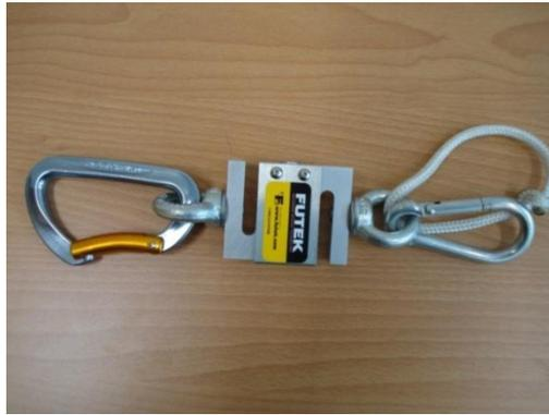
**Fig. 12 :** Capteur de force et boucles de fixation.
