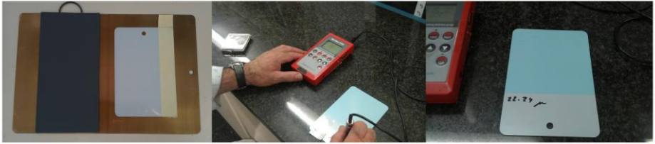
Figura 19. Proceso de medición de espesor de la capa aplicada
