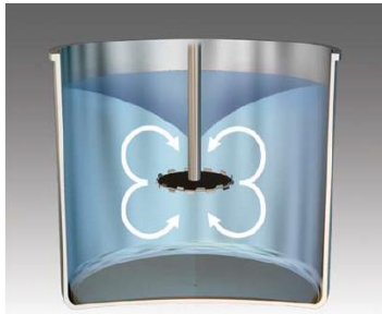
Figura 8. Patrón de flujo en un tanque agitado con Cowles (imagen extraída de la ref.2)
