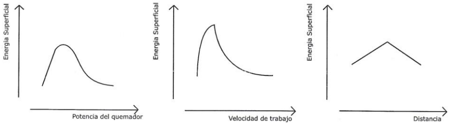
Figura 15. Comportamiento de la energía superficial (imagen extraída de la ref.9)
