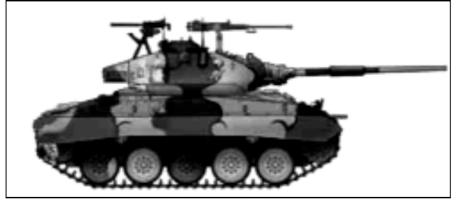
Carro M-24 modernizado con nuevo GMP y Cañón AV de 60 mm.
