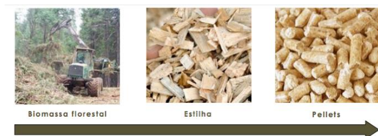
Figura 21 - Tipos de conversão de biomassa sólida (Ventil, 2012)
