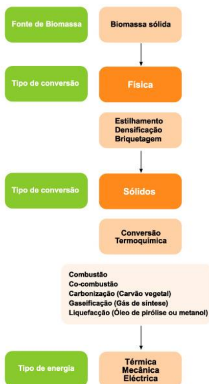
Figura 20 – Descrição de processo de conversão de Biomassa (Energiasrenovaveis, 2014)
