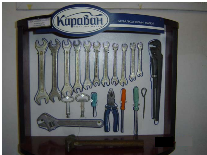
Рис. 4.7. Приклад силуетного зберігання слюсарного інструменту
