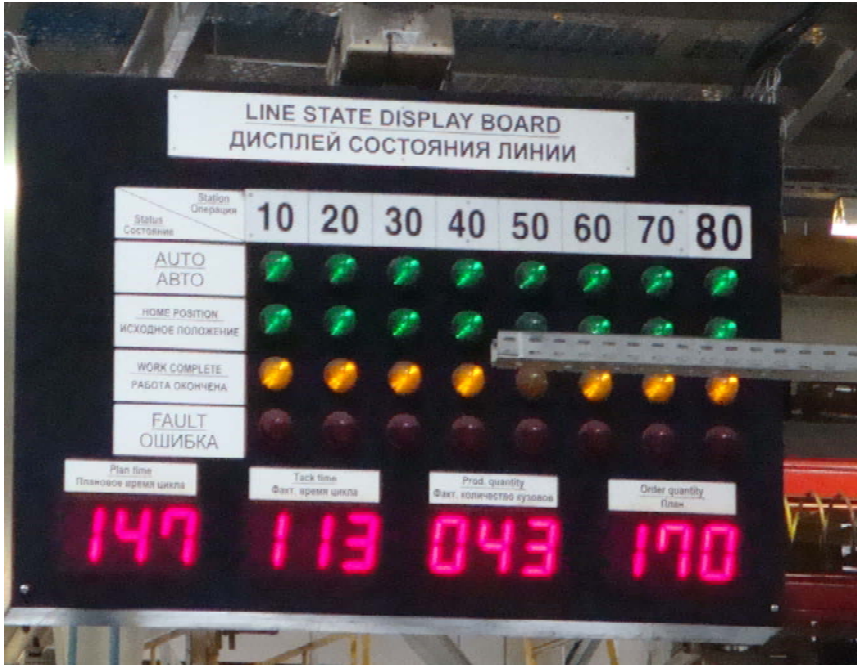
Рис. 3.8. Приклад складного андону, що використовується в зварювальному цеху ЗАТ «АвтоЗАЗ»
