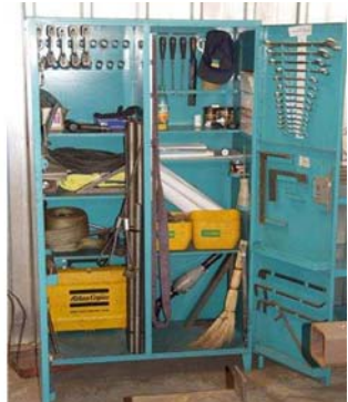
Рациональне розміщення інструментів, підтримування чистоти в шафі ремонтного робітника
