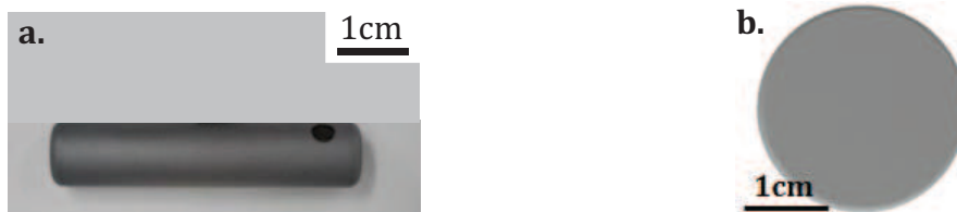
Figure II-4 : a. Image d'une éprouvette cylindrique pour la détermination de la cinétique d'oxydation cyclique, b. Image d'une pastille pour la détermination de la durée de vie des systèmes barrière thermique en cyclage thermique
