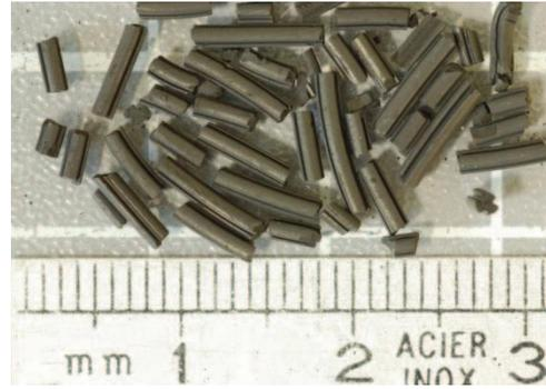
Figure 89 – Dimensions caractéristiques des particules de catalyseur
