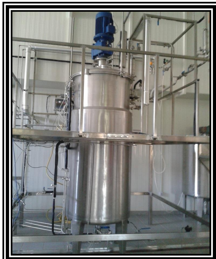
Figure II.2. Bioréacteur de 1000 L
